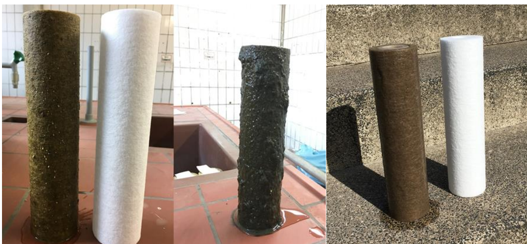
Abbildung 66: Belegung der Vorfilterkerzen: links: kommunale Anlage, 2 d Betrieb; Mitte: vermehrtes Algenaufkommen; rechts: industrielle Anlage, 2 d Betrieb
