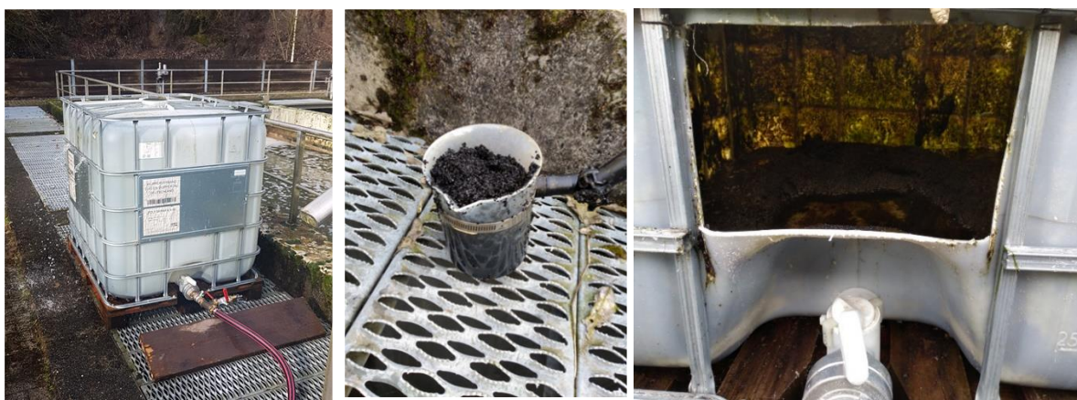
Abbildung 72: „Schnellbeladung“: Versuchsreaktor (links), Aktivkohle nach Beladung (Mitte) und aufgeschnittener Reaktor nach Versuchsende (rechts)
