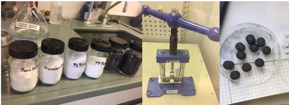
Abbildung 10: Erzeugung von Mustertabletten: Einsatzstoffe, Tablettenpresse, Mustertabletten (v. l. n. r.)
