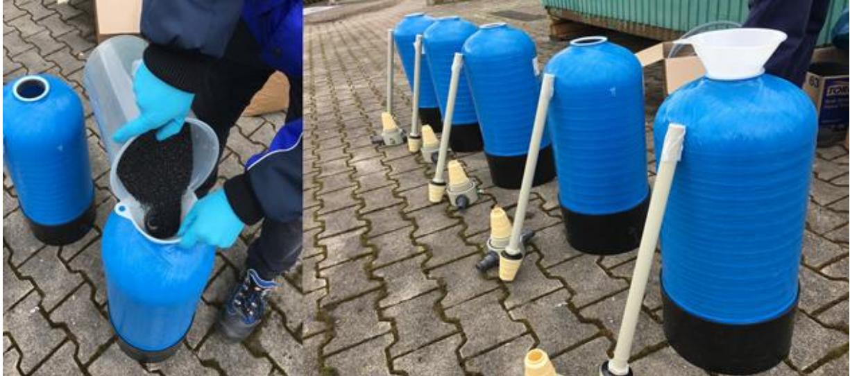
Abbildung 65: Befüllen der 24 l Adsorber mit Aktivkohle DGK
