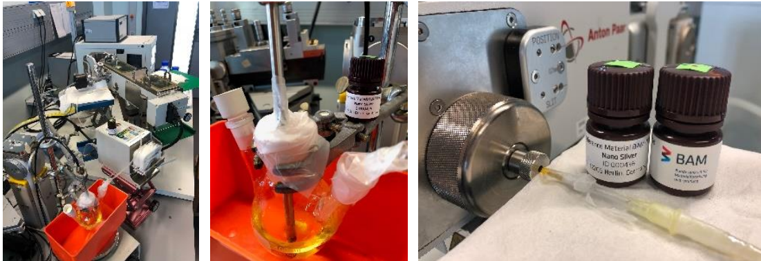
Abbildung 7: SAXS-Anlage von Anton Paar mit Aufbau der in situ -M8-Messungen in Nano Silber N008
