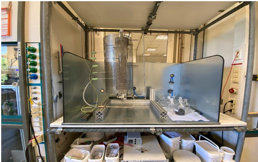
Abbildung 42: Aufbau des ESFA-Reaktors
