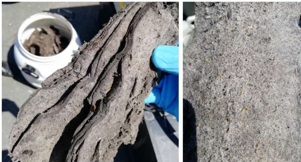
Abbildung 43: Separierte Faserfraktion nach der Behandlung von Primärschlamm (Trommelzentrifuge)
