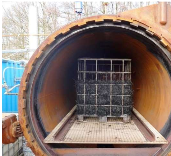
Abbildung 52: Reaktor (Durchmesser 2 m) zur Behandlung der Faserfraktion mit DK
