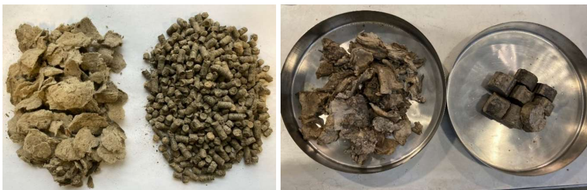
Abbildung 46: Getrocknete Faserfraktion und hergestellte Pellets (l.) sowie hergestellte Briketts (r.)
