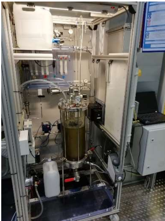
Abbildung 66: Versuchsreaktor (l.) und enthaltene Granular-Partikel (r.) zum anaeroben Abbau der separierten Flüssigkeitsphase
