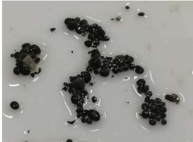
Abbildung 66: Versuchsreaktor (l.) und enthaltene Granular-Partikel (r.) zum anaeroben Abbau der separierten Flüssigkeitsphase
