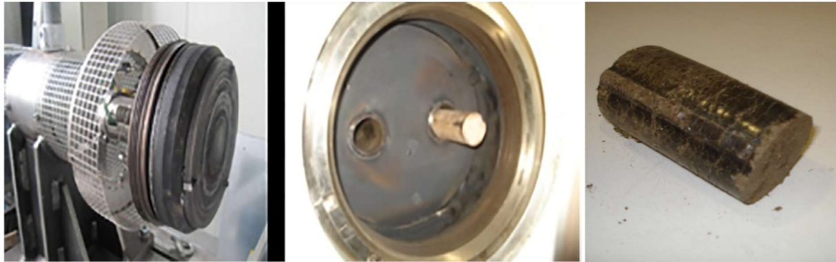
Abbildung 48: Heiße, ablativ Scheibe (l.), Zuführöffnung für Biomasse (m.) und Rundstab aus der separierten Feststofffraktion des PS (r.)
