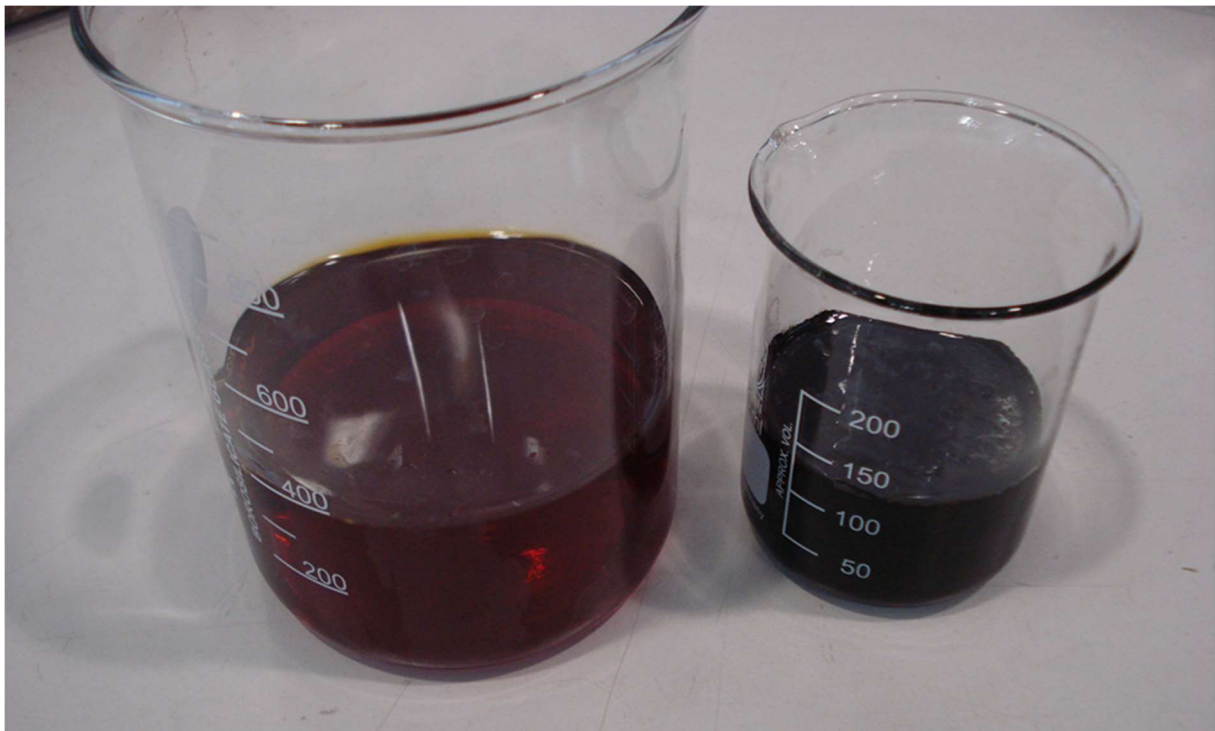
Abbildung 50: Wässrige Kondensatfraktion (l.) und ölhaltige Kondensatfraktion (r.)
